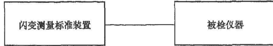
图 9 标准源法闪变值检定示意图
