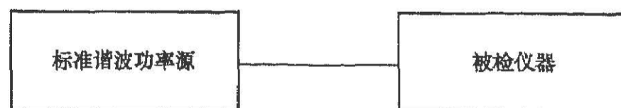
图 7 标准源法谐波有功功率检定示意图
